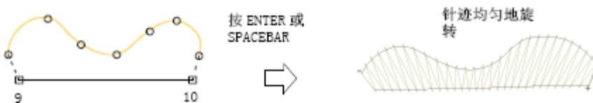
提示 您可以通过“切割”形状的尖锐端点和使标注的第一参考点和最后参考点离得远些来控制针迹角度。
