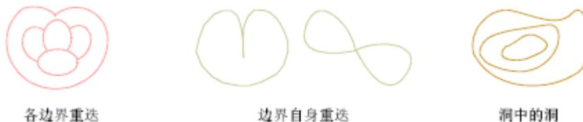
此情况发生时复合填针形状中的重叠边界将被忽略，在边界定义的最大面积范围内产生针迹。
