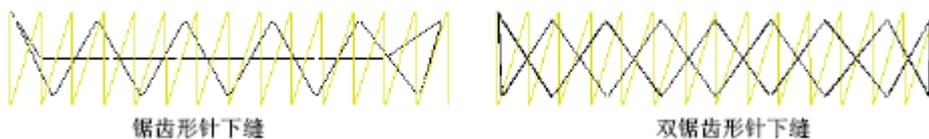
您可以为锯齿形针和双锯齿形针下缝设定间距和针迹长度属性值。
