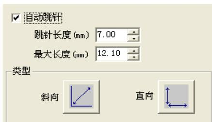
3. 在最大针迹域中，输入允许的最大针迹长度。超过此值的针迹将会使用自动跳针。
